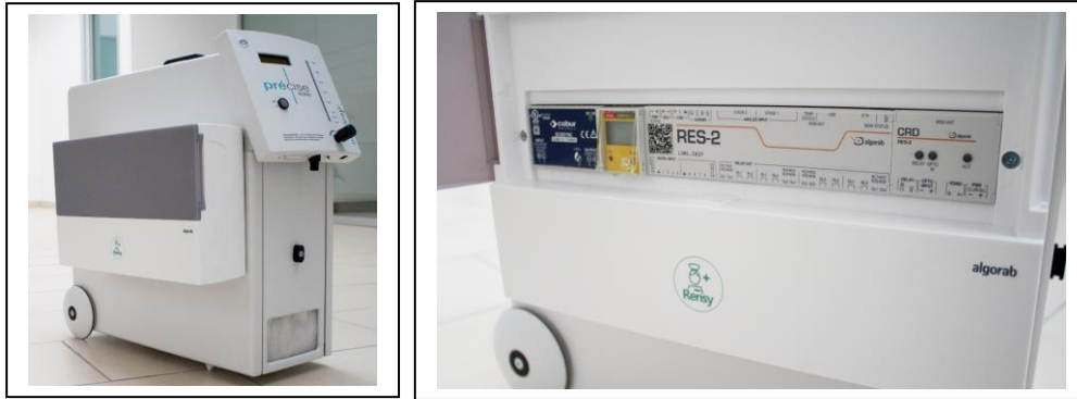
Fig. 2 Prototipo di piattaforma locale (Rensy) applicato ad un concentratore d'ossigeno in sperimentazione
