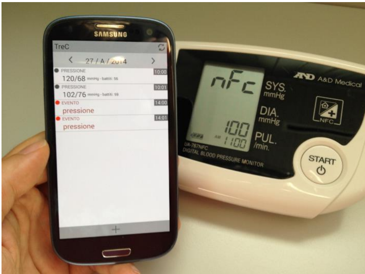
Figura 1: il kit diagnosi ipertensione (Hyper-kit) composto da misuratore elettronico con NFC e smartphone con installata la app Hyper-Logbook.
